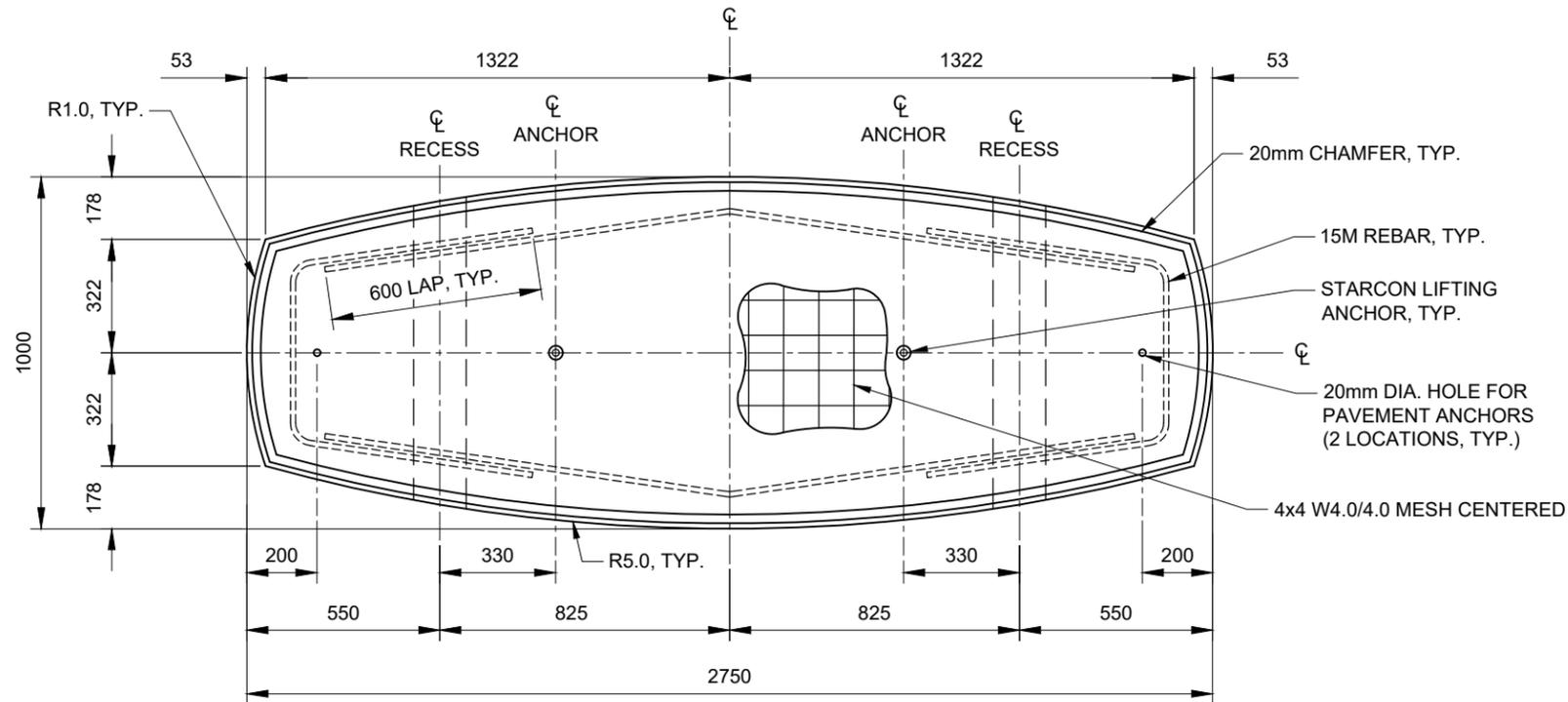
**PRE-CAST CONCRETE CURB - PLAN VIEW**
